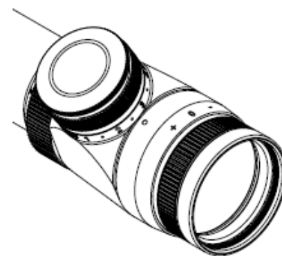
Барабанчик регулировки подсветки у VX-3 и других прицелов располагается на окуляре
